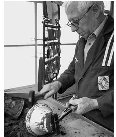
Vorne das Bleimodel, hinten das sandgeformte Kernstück. Philipp Walpen giesst die heisse Bronzelegierung (80% Kupfer, 20% Zinn). 20 Min. nach dem Giessen klopft er den spröde gewordenen Formsand innen und aussen von der fertigen Glocke.
